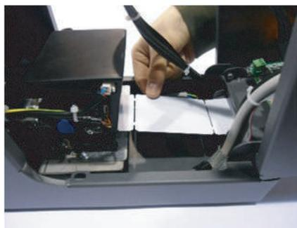
2 - Правильное техническое обслуживание требует, чтобы снятие принтера было без отсоединения кабелей. Отверните крепежный винт под принтером, снимите его с опоры и положите в удобном для чистки положении.
