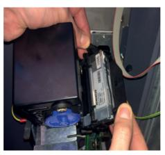
4 - Очистите два передних датчика, два задних и волочильный ролик бумаги сжатым воздух, затем протрите антистатической тканью.
