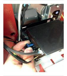
4 - Переставьте синий рычаг принтера в исходное положение, вытягивая его наружу двумя щелчками. Правильная операция подтверждается зеленым светодиодом.
