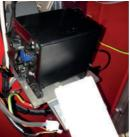
2 - Для правильного технического обслуживания принтер должен снят без отключения кабелей данных и питания. Открутите фиксирующую ручку под принтером, снимите оборудование с кронштейна, поместив его в удобное положение для очистки.
