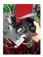
3 - Возьмите баллон со сжатым воздухом без масла и антистатическую ткань. Нажмите на два боковых крыла, откройте принтер и очистите внутреннюю часть устройства.
